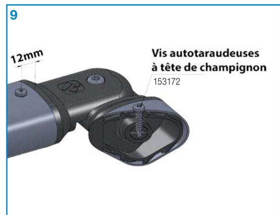
S'il y a une rupture dans le garde-corps, placez les pièces de coin en plastique à l'extrémité de la main courante et de la latte de genoux. Vous pouvez fixer l'angle à l'aide de 2 vis autotaraudeuses à tête de champignon (4,8 x 25 mm).
