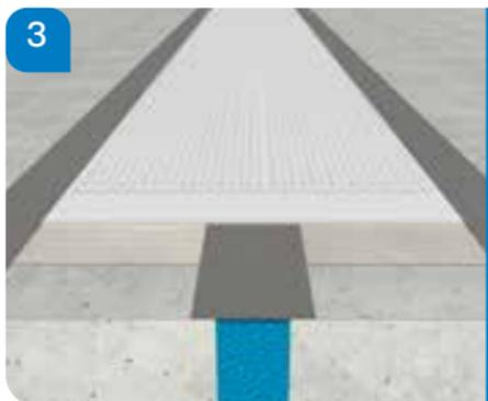
Das im Vorfeld zugeschnittene Vlies in die frische Einbettschicht einlegen und mit der Rolle blasenfrei einarbeiten.
