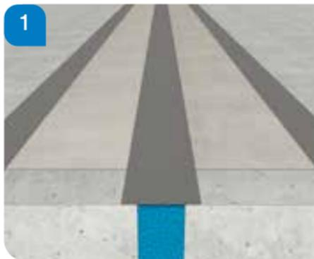
Vor Beginn der Abdichtungsarbeiten, Anschlussbereiche reinigen und mit PVC-beschichtetem Abdeckband abkleben.
