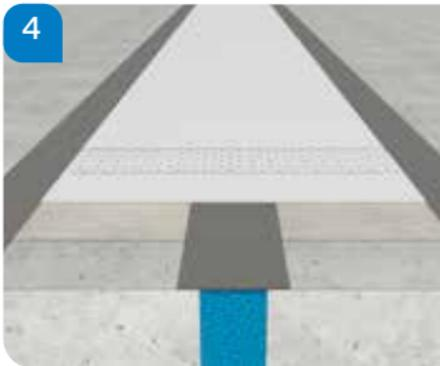
Ohne Wartezeit kann dann direkt das Vlies mit einer weiteren Schicht überdeckt werden. Verbrauch: ca. 1.0 bis 1.3 kg/m<sup>2</sup>. Auch im Randbereich entlang der Ablebung genügend Material aufbringen.
