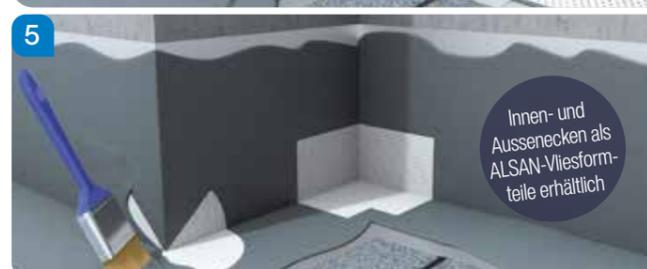
Das Vlies mit einer weiteren Schicht überdecken.
