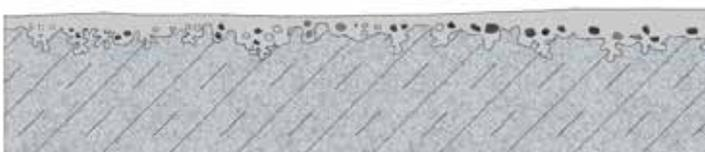
Qualora fosse necessario preparare grandi superfici per un rivestimento, la pallinatura è la prima scelta. Con questo metodo viene asportato il materiale di qualità inferiore situato sullo strato superiore. I componenti instabili vengono rimossi.
