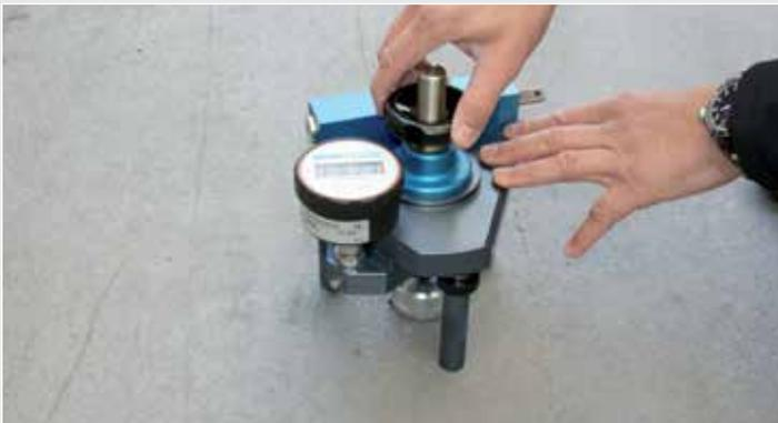
3. Per la realizzazione di una giunzione duratura fra il materiale di rivestimento e il sottofondo è indispensabile garantire una forza di aderenza sufficiente. Per **superfici cementizie** è necessario raggiungere **una resistenza di >1,5 N/mm<sup>2</sup>** e per **sottofondi in asfalto una resistenza di > 0,8 N/mm<sup>2</sup>**.
