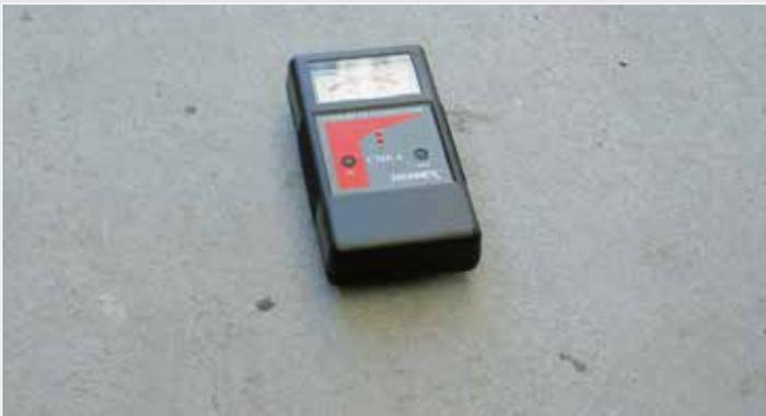
2. Al momento di esecuzione dei lavori di rivestimento, il sottofondo può presentare **al massimo il 5% (riferito alla massa) o il 16% (riferito al volume)** di umidità. Tramite metodi di misurazione elettronica è possibile determinare tale dato in maniera precisa e non distruttiva con un adeguato misuratore di qualità, fino a una determinata profondità. Un metodo più preciso indipendentemente dallo spessore dello strato è il "Metodo CM".
