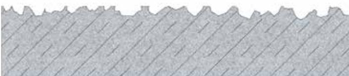
Si viene a creare una ruvidità con una testurizzazione superficiale relativamente uniforme, che dà un contributo all'aderenza. Anche i pori, che avevano uno strato di copertura molto sottile, vengono appianati mediante la sabbiatura.
